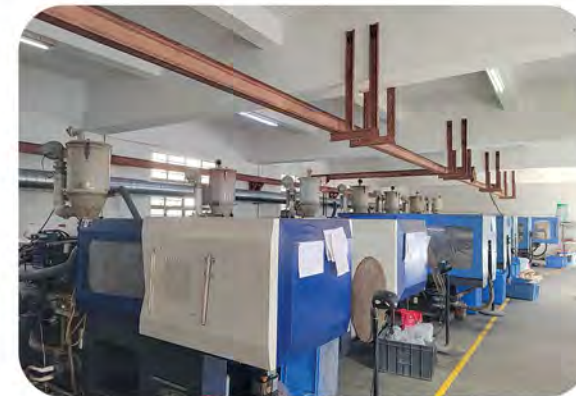
注塑车间 Injection Department 注塑机: 10台 Injection Molding Machines: 10 碎料机: 3台 Regrinding Machines: 3 吹塑机: 3台 Blow Molding Machines: 3
